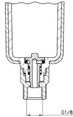
Se si vuole evitare lo scarico della condensa è sufficiente ruotare l'elemento di manovra in senso
